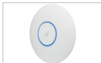
Access-Point (über Netzwerkkabel angeschlossen und gibt die konfigurierte Bandbreite weiter)
